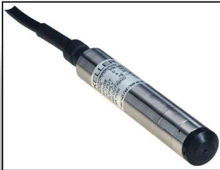
Diese Drucktransmitter mit 4-20 mA Analogausgang kommen bei allen Wasserstandsmessungen zum Einsatz, die eine hohe Präzision erfordern ist. Sie vereinen die neuesten technologischen Fortschritte im Bereich Druckaufnehmer und Kompensationselektronik. Die Sonde ist mit Kabellängen von 10,15,25 und 40 Metern verfügbar.
